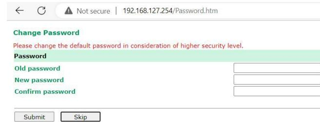
**Nota:** Si olvida su contraseña, la ÚNICA forma de configurar el NPort 6000 es con el botón de reinicio para restablecer todas las configuraciones y cargar los valores predeterminados de fábrica. Si ha deshabilitado el botón de reinicio en la configuración de su NPort 6000, aún puede utilizarlo para cargar los valores predeterminados de fábrica dentro de los primeros 60 segundos posteriores al encendido del NPort 6000.
