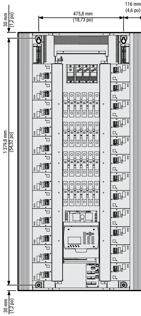
**Note:** Les trous de montage (sur tous les modèles) ont un diamètre de 10,5 mm (0,41 po).
